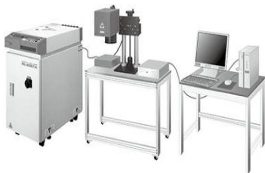
图4 激光焊设备系统示意图
